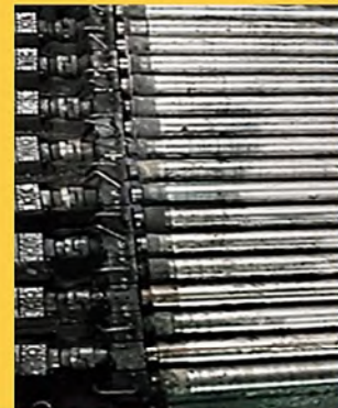
تخریب سطح رولر اسکرین ها به دلیل استفاده از بغل گیر های تفلونی
