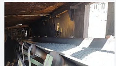
ریزش بار به صورت یکنواخت بر روی نوار نقاله C1
